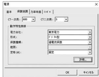
「電源」の保護協調タブ：電力会社の配変OCRに接続されるCTの値や電力会社、形式(東京電力の場合、誘導型、静止型、デジタル型)を設定する
