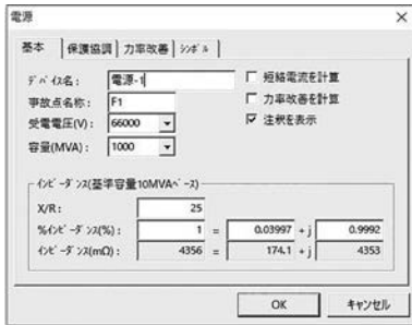
「電源」の基本タブ：電力会社から受電する電圧や電力会社変電所の電源容量、インピーダンスなどを設定する
