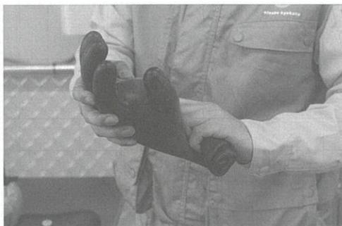
試験装置にセットする前に、ピンホールの有無をチェック。指先に空気を押し込み、ニア漏れ音がないか確認する。
