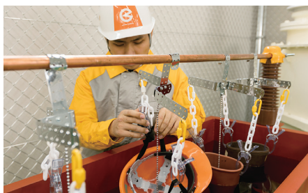
ヘルメット、ゴム手袋、長靴耐電圧試験
